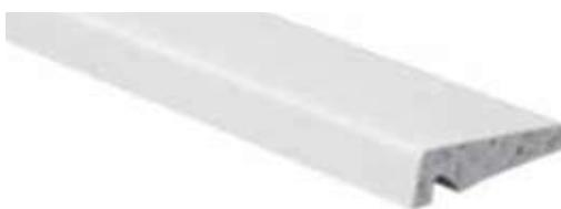
PIEZA QUE SE COLOCA HORIZONTALMENTE Y QUE CUMPLE UNA FUNCIÓN ESTÉTICA DE DAR CONTINUIDAD A LA LÍNEA DEL VIERTEAGUAS Y DEL DINTEL ENTRE VENTANA Y VENTANA. PRESENTA GOTERÓN INFERIOR. LAS PIEZAS SON TOTALMENTE MANEJABLES DEBIDO A SU LIGEREZA Y SE FABRICAN A MEDIDA ESTÁNDAR 130 CM.
